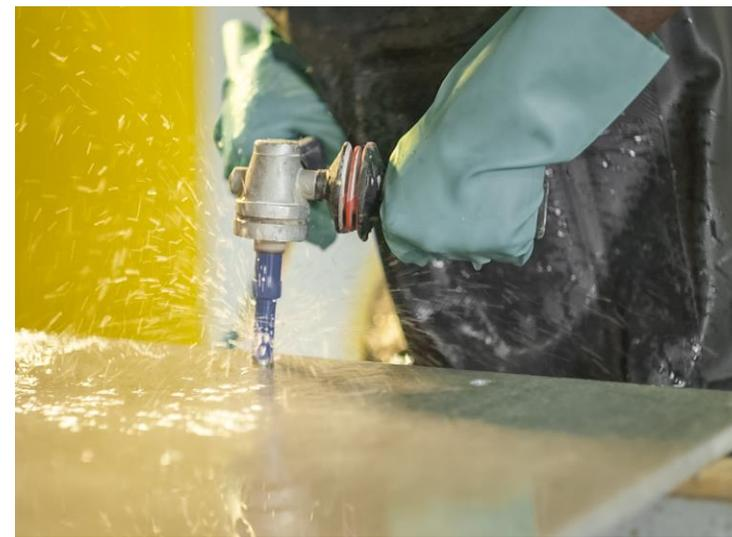
Осуществляйте резку, фрезерование, сверление и полировку с подачей воды ручными инструментами
