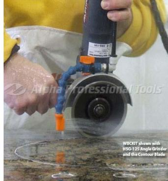
**Набор для мокрого реза для шлифовальной машины**
